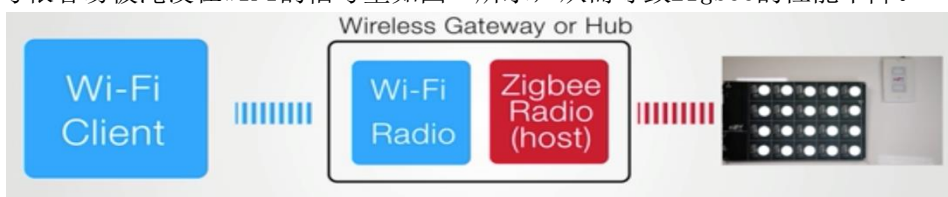
图 A.1 Zigbee 和 WiFi 的共存的网关或者 hub
